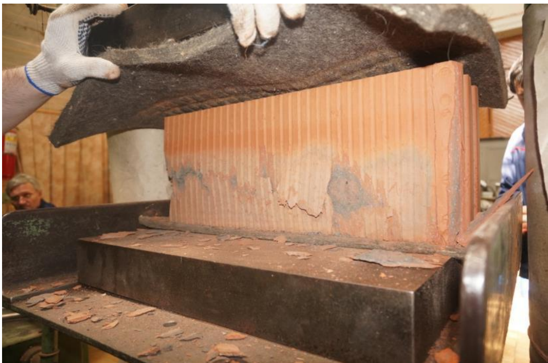
Рис. 2.8. Общий вид и характер разрушения камня 11.5 НФ (Pороматх-200) при приложении нагрузки перпендикулярно опорной грани
