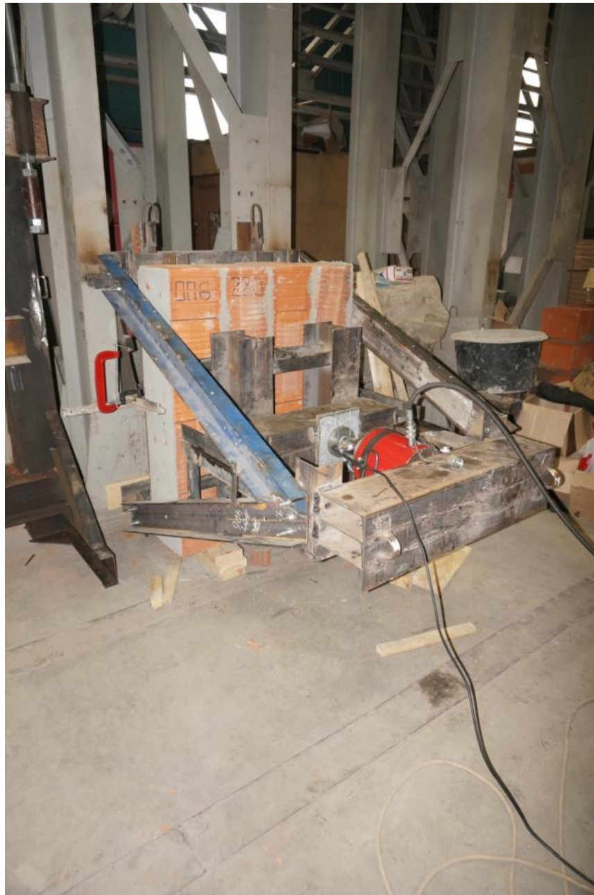
Рис.3.2. Общий вид силовой рамы для испытаний на изгиб образцов, установленных вертикально
