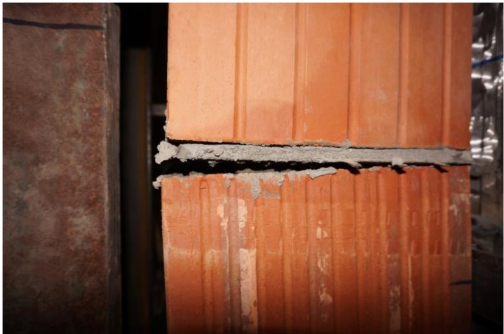
Рис.3.17. Общий вид опытного образца из камня (Poromax-280) до и после испытания на изгиб из плоскости по неперевязанному сечению (схема испытания -2)
