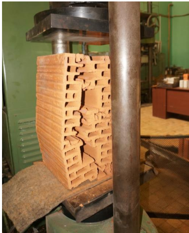
Рис. 2.13. Общий вид и характер разрушения камня 12.3 НФ (Рогомах-280) при приложении нагрузки перпендикулярно торцевой грани
