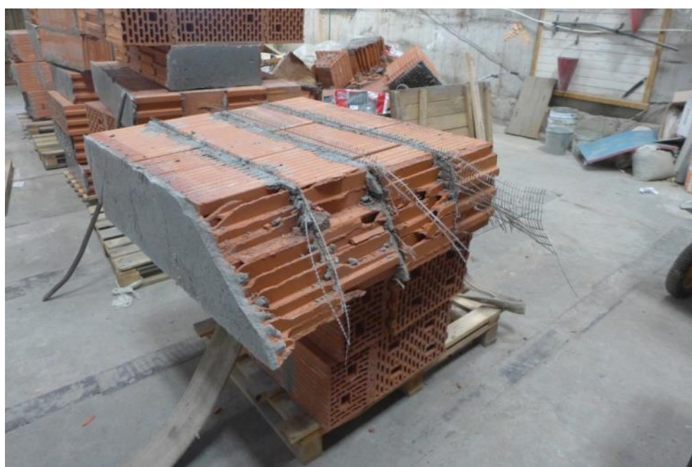
Рис.3.37 Характер разрушения армированного образца серии ОП
