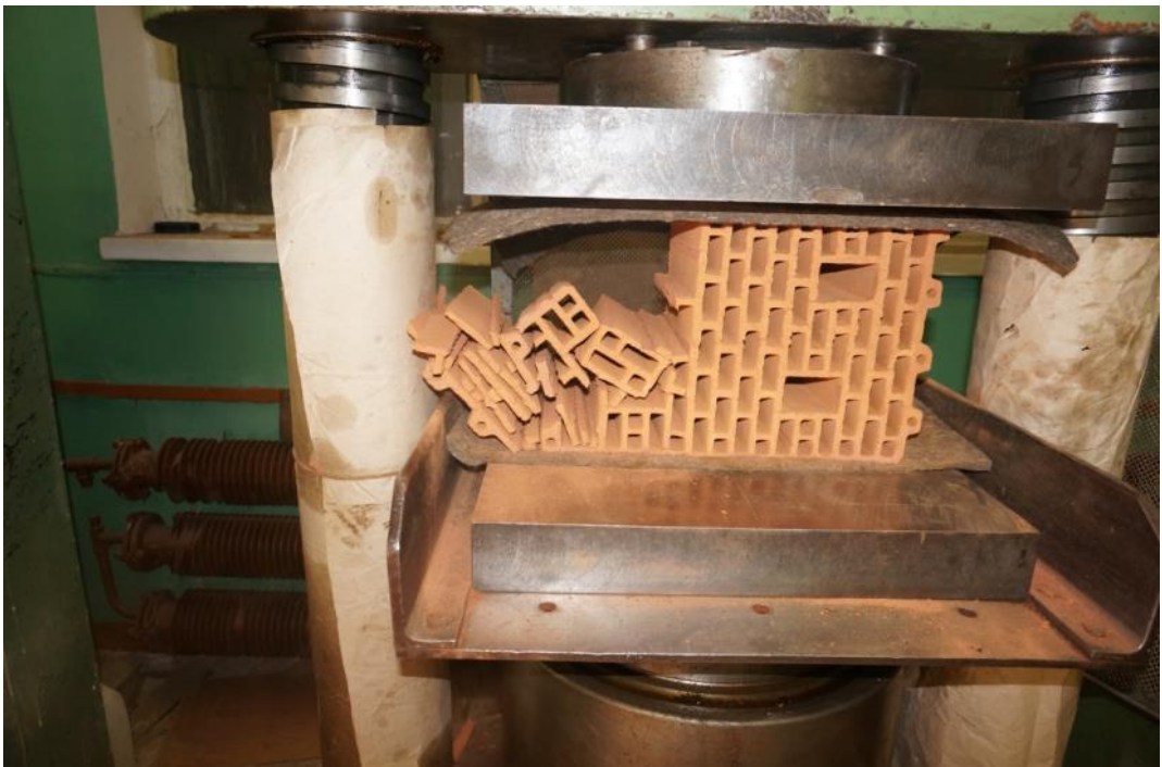
Рис. 2.11. Общий вид и характер разрушения камня 12.3 НФ (Porotax-280) при приложении нагрузки перпендикулярно боковой грани
