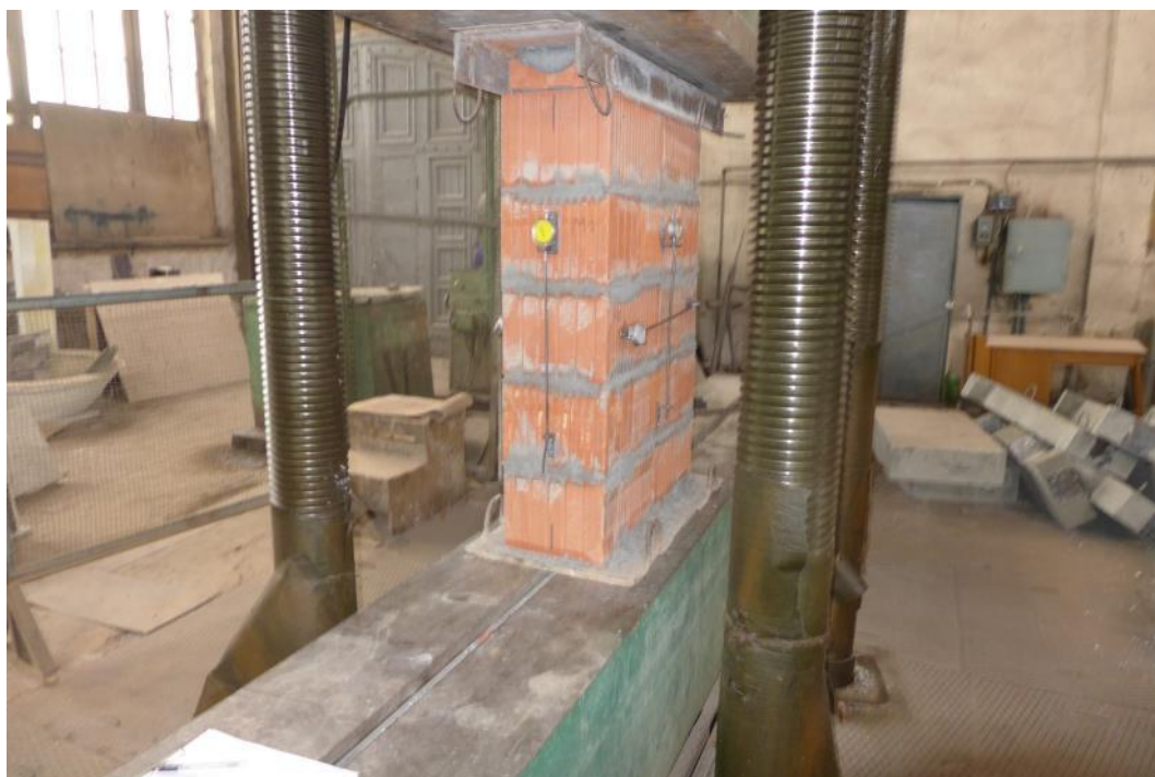
Рис. 3.51. Общий вид опытного образца, выполненного из крупноформатных камней марки Rogomax-280
