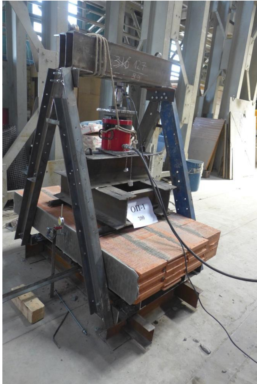
Рис.3.1. Общий вид силовой рамы для испытаний на изгиб образцов, установленных горизонтально
