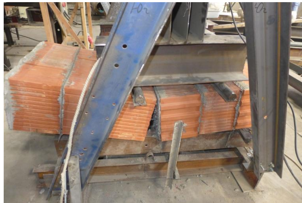
Рис. 3.16. Общий вид опытного образца (Рогомах-280), армированного базальтовой сеткой до и после испытания на изгиб по неперевязанному сечению (схема испытания – 1)
