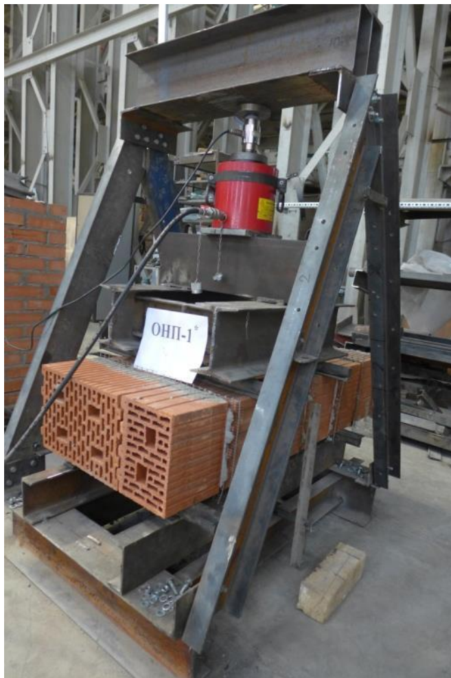
Рис. 3.16. Общий вид опытного образца (Рогомах-280), армированного базальтовой сеткой до и после испытания на изгиб по неперевязанному сечению (схема испытания – 1)
