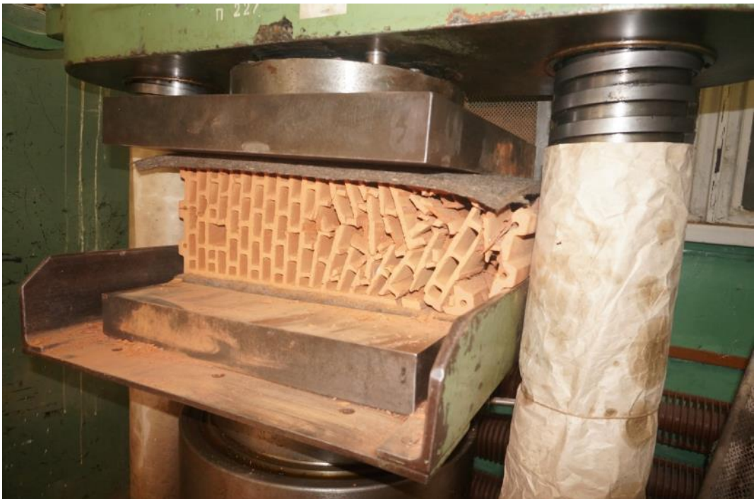
Рис. 2.10. Общий вид и характер разрушения камня 11.5 НФ (Pоротах-200) при приложении нагрузки перпендикулярно боковой грани
