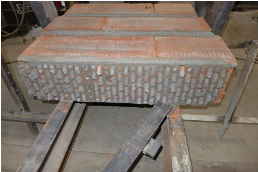
Рис.3.18. Характер структуры шва опытного образца после испытания на изгиб по неперевязанному сечению
