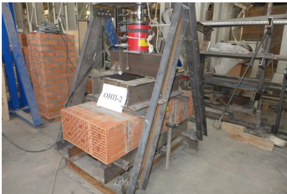
Рис.3.15. Общий вид образца серии ОНП (Рогомах-280) до и после испытания на изгиб по неперевязанному сечению (схема испытания -1)
