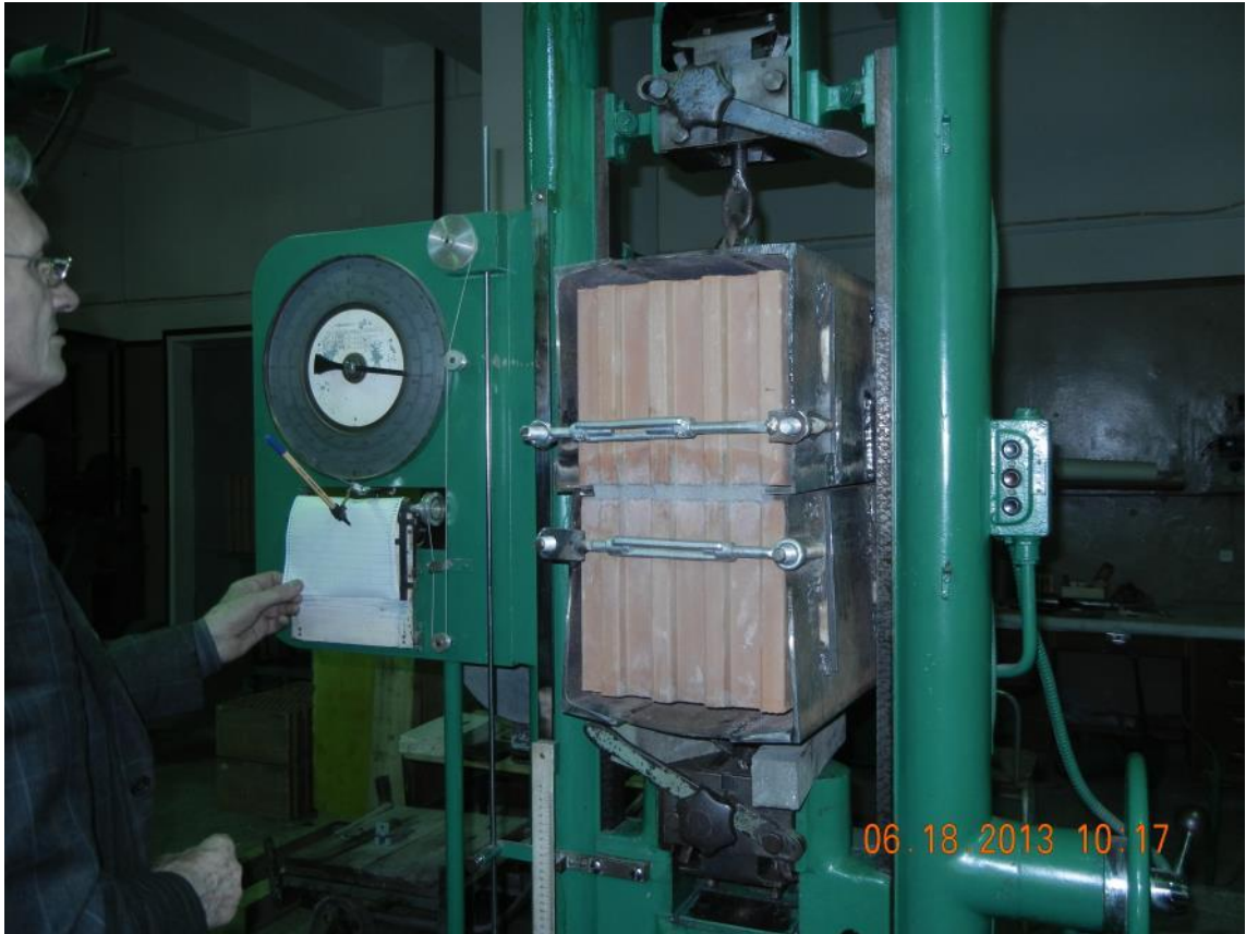
Рис. 2.6. Образец-двойка для испытания на нормальное сцепление
