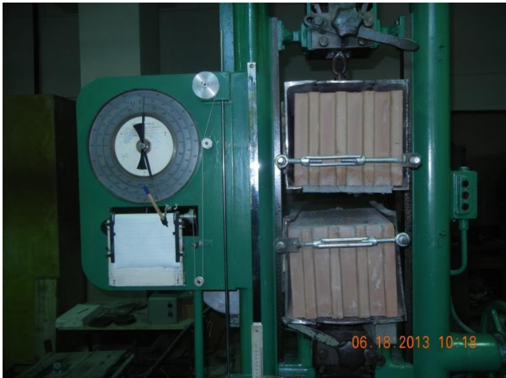
Рис. 2.17. Общий вид опытного образца в прессе до и после испытаний на осевое растяжение
