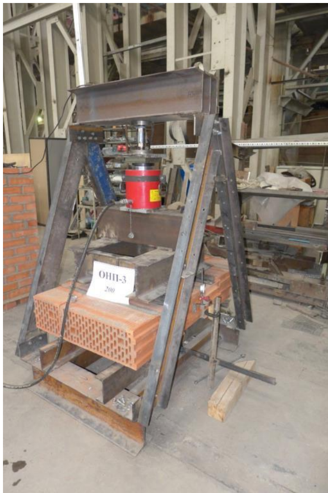
Рис. 3.12. Общий вид образца (Роготах-200) до и после испытания на изгиб по неперевязанному сечению (схема испытания -1)
