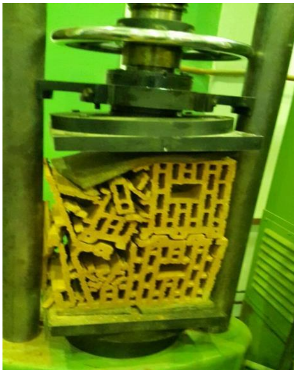
Рис. 2.14. Общий вид и характер разрушения камня, состоящего из двух половинок 6.1 НФ (Рогомах-280-1/2-Д) при приложении нагрузки перпендикулярно торцевой грани
