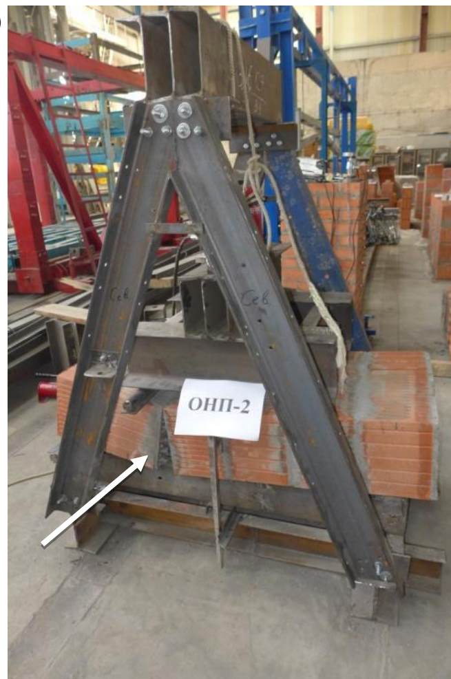
Рис.3.15. Общий вид образца серии ОНП (Рогомах-280) до и после испытания на изгиб по неперевязанному сечению (схема испытания -1)
