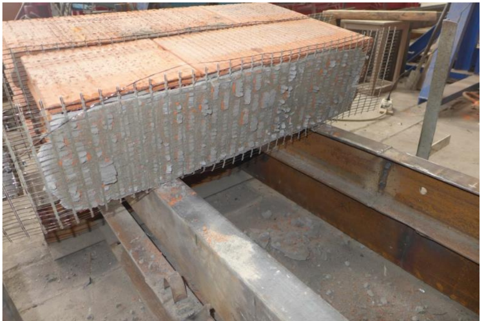
Рис.3.19. Характер структуры шва опытного образца после испытания на изгиб по неперевязанному сечению (образец, армированный базальтовой сеткой)
