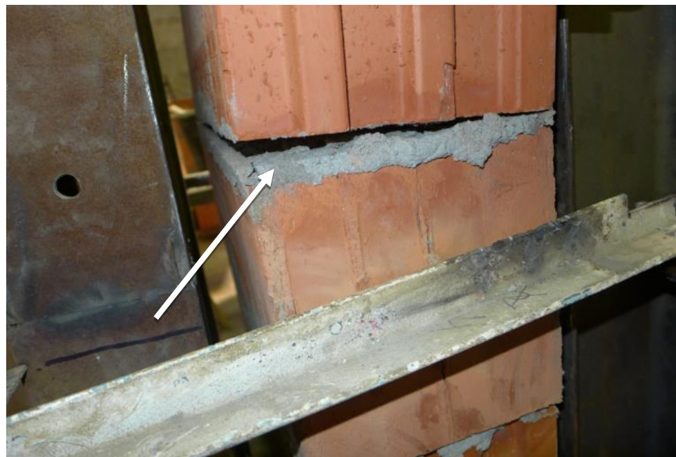
Рис. 3.14. Общий вид образца серии ОНП (Pogomax-280) до и после испытания на изгиб по неперевязанному сечению (схема испытания -2)
