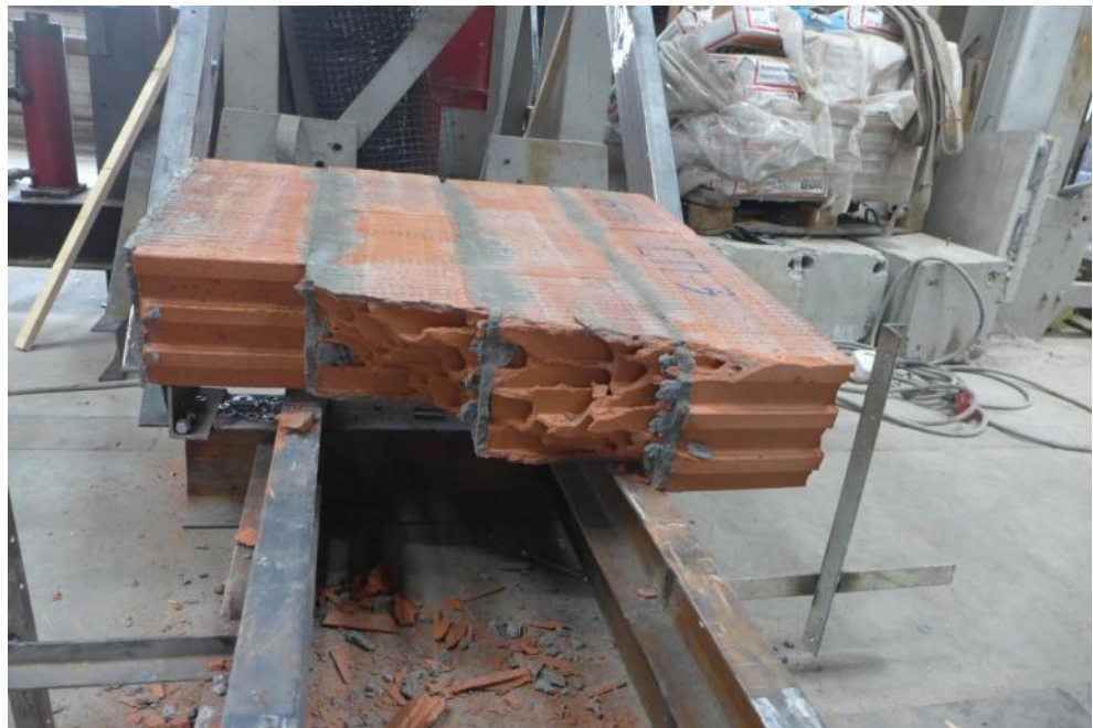
Рис.3.36. Характер разрушения образца серии ОП
