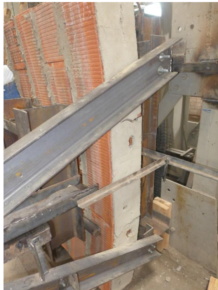
Рис.3.32. Общий вид образца (Poromax-200) до и после испытания на изгиб по перевязанному сечению (схема испытания – 2)
