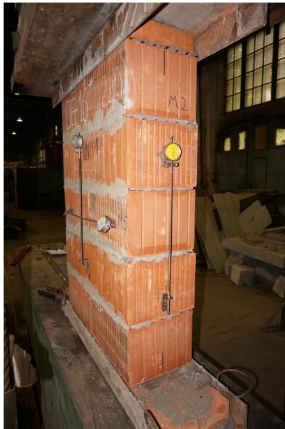
Рис.3.52. Общий вид опытного образца, армированного базальтовой сеткой и выполненного из крупноформатных камней марки Роготах-280
