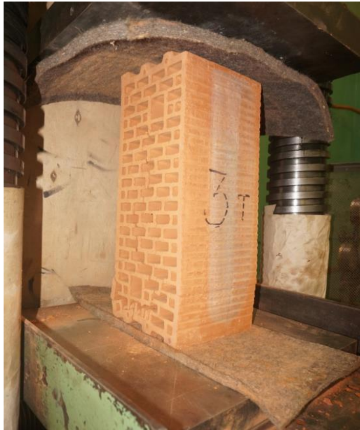
Рис. 2.12. Общий вид и характер разрушения камня 11.5 НФ (Рогомах-200) при приложении нагрузки перпендикулярно торцевой грани
