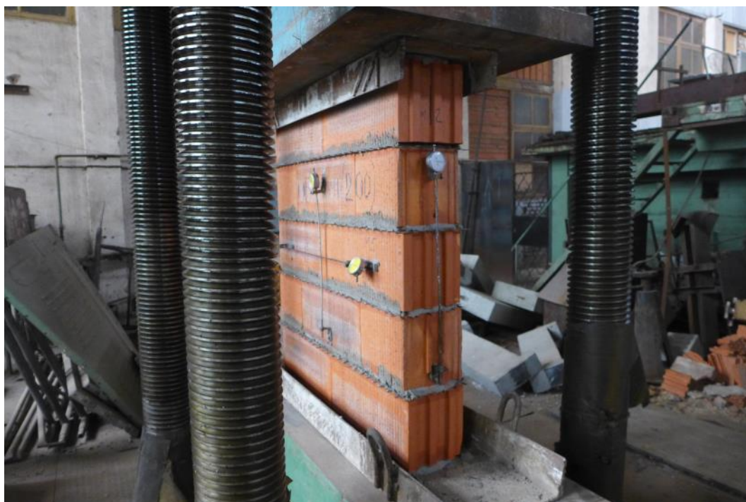
Рис. 3.49. Общий вид опытного образца, выполненного из крупноформатных камней марки Роготах-200
