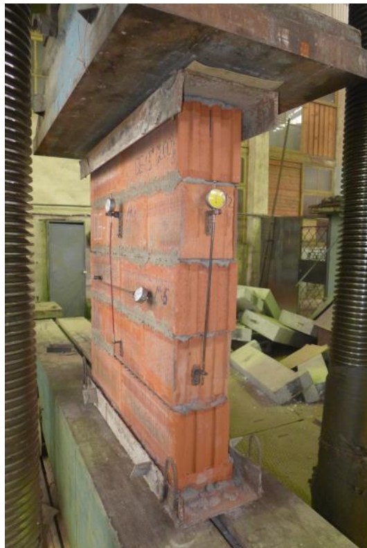
Рис. 3.50. Общий вид опытного образца, армированного базальтовой сеткой и выполненного из крупноформатных камней марки Роготах-200
