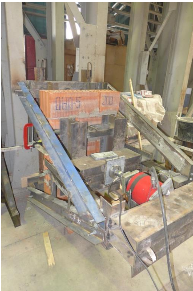
Рис. 3.14. Общий вид образца серии ОНП (Pogomax-280) до и после испытания на изгиб по неперевязанному сечению (схема испытания -2)
