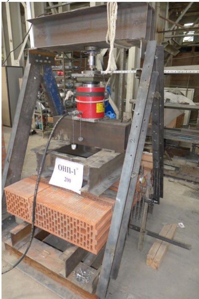
Рис.3.13. Общий вид опытного образца из камня Poromax-200 до и после испытания на изгиб по неперевязанному сечению. Схема испытания – 1 (стрелками показаны зоны трещин)
