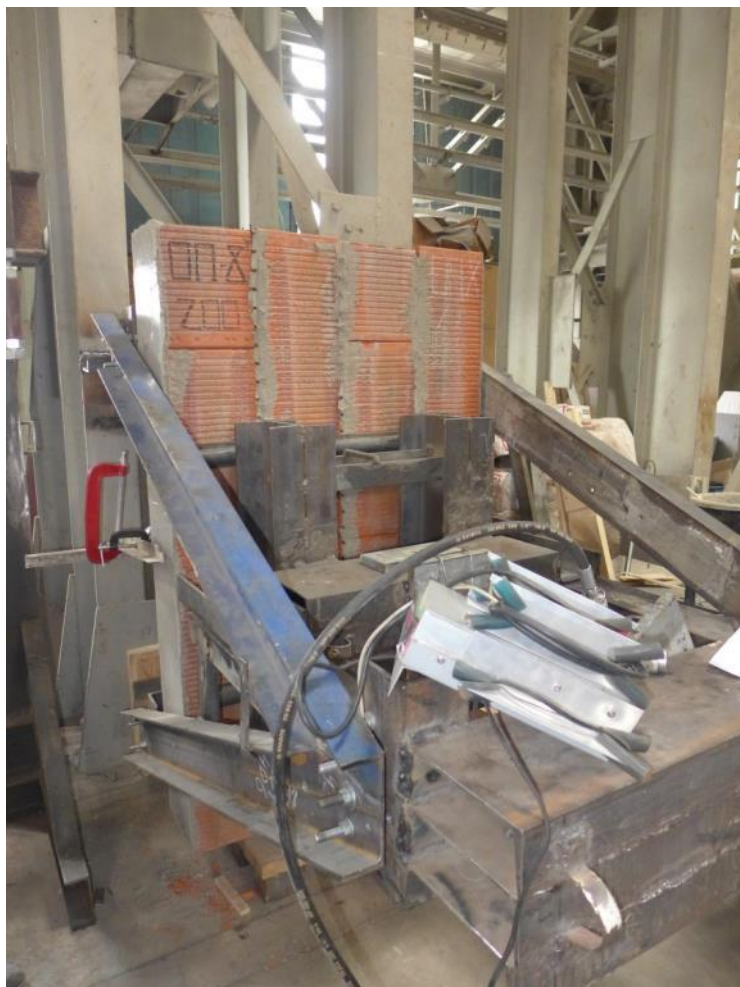
Рис.3.32. Общий вид образца (Poromax-200) до и после испытания на изгиб по перевязанному сечению (схема испытания – 2)
