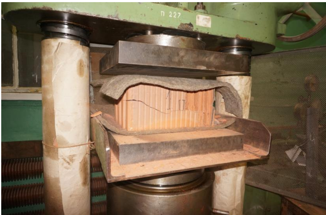
Рис. 2.9. Общий вид и характер разрушения камня 12.3 НФ (Рогомах-280) при приложении нагрузки перпендикулярно опорной грани
