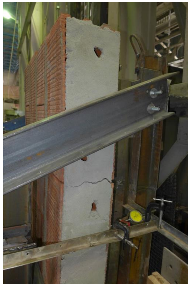
Рис.3.31. Общий вид образца (Pogomax-200) до и после испытания на изгиб по перевязанному сечению (схема испытания – 2)
